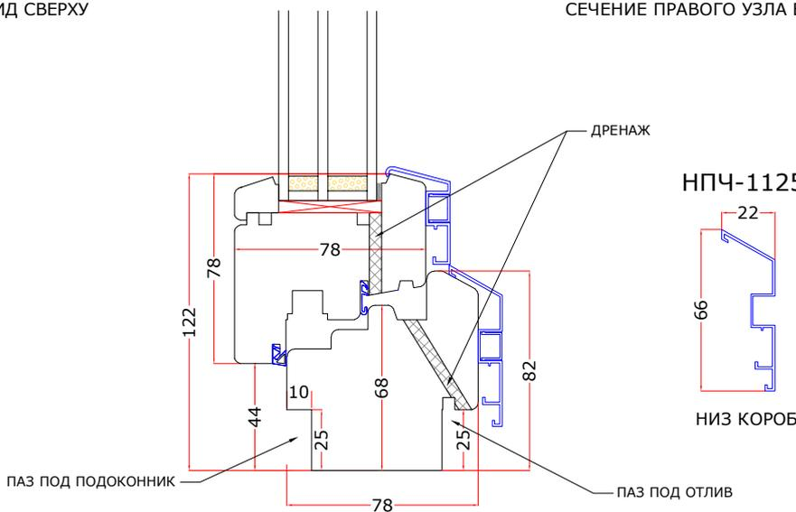
РАЗРЕЗ НИЖНЕГО УЗЛА
