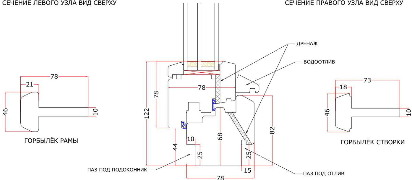
РАЗРЕЗ НИЖНЕГО УЗЛА
